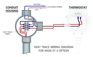
Figure 3.11-2- ET2 & ET3 Wiring
