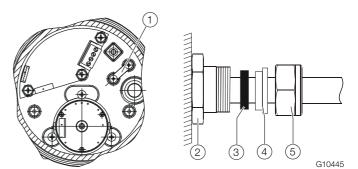
Fig. 5:Connection using a flameproof cable gland(1)Strain relief(2)M25 x 1.5 / 1/2"-NPT adapter(3)Gasket(4)Sleeve(5)Union nut
